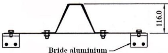
Fixation par brides en aluminium sur couverture à joint debout.
